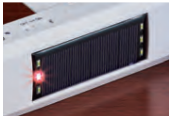
ブザーと同時に赤色 LED 1 個点滅
