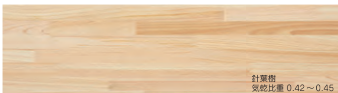
ラジアタパイン集成材 (フィンガージョイント)
